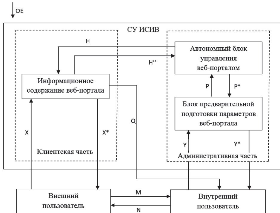
Рис. 2. Детальная структура СУ ИСИБ
