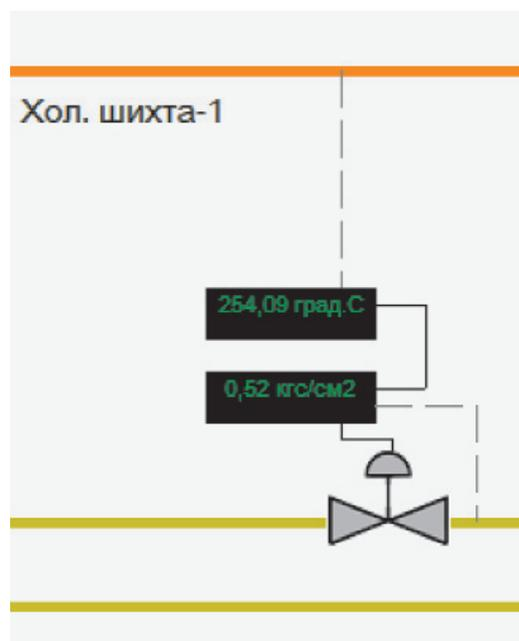
Рис. 2. Внешний вид регулирующего клапана в тренажере
