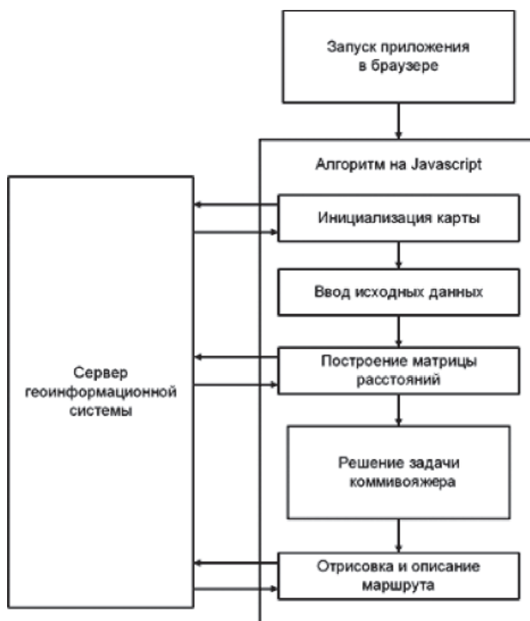
Рис. 1. Схема общего алгоритма работы приложения для построения автомобильных маршрутов
