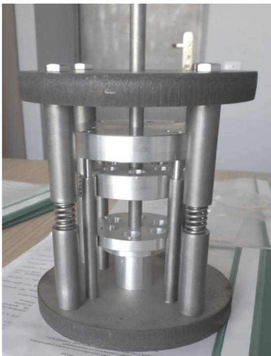
Рис. 4. Макет виброизолирующей подвески с компенсатором жесткости на основе неодимовых магнитов
