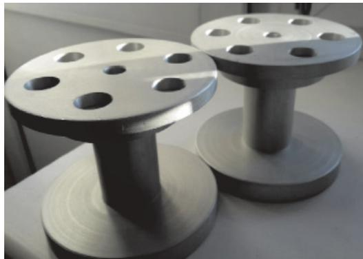
Рис. 3. Дюралюминиевые диски для установки супермагнитов
