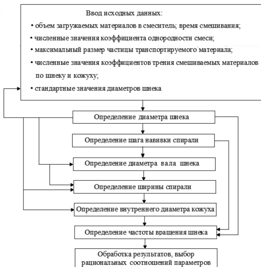
Рис. 3. Алгоритм расчета параметров вертикального шнека смесителя сыпучих материалов
