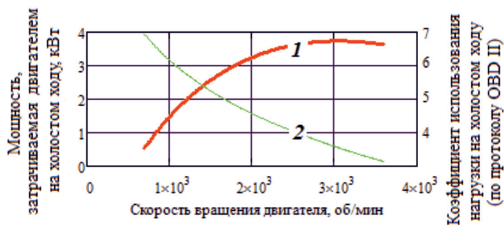
Рис. 3. Изменение мощностных потерь двигателя при работе на холостом ходу; 1 – абсолютные величины, полученные расчётным методом; 2 – относительные величины, получаемые по протоколу OBD II
