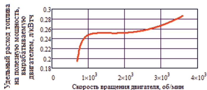
Рис. 4. Изменение удельного расхода топлива на полезную мощность, вырабатываемую двигателем, от его оборотов
