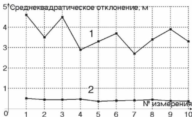
Рис. 4. Значения среднеквадратического отклонения определения местоположения при различных измерениях
