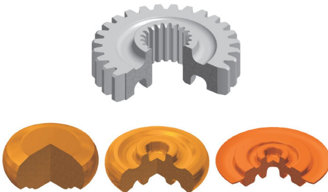
Рис. 1. Деталь «Шестерня» и технологические переходы изготовления её поковки
