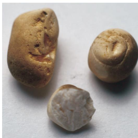
Рис. 5. Каталитический носитель ШН-2 с покрытием платиной
