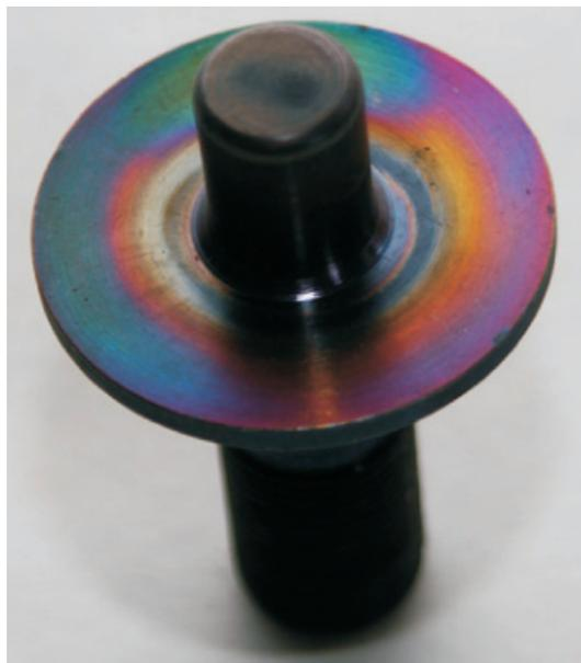
Рис. 8. Выступ камеры сгорания дизеля с переменной геометрией соединительного канала после ионной имплантации
