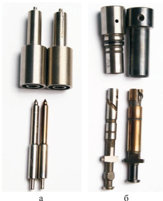
Рис. 4. а – распылители завода ЯЗДА (г. Ярославль) (справа после обработки ионной имплантацией); б – плунжерные пары топливного насоса дизеля (справа после обработки ионной имплантацией)
