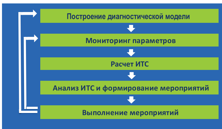
Рис. 1. Этапы оценки технического состояния
