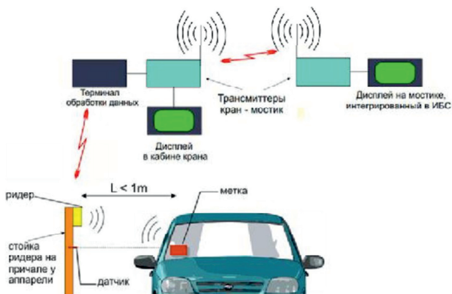
Рис. 3. Схема действия RFID-системы контроля погрузки-разгрузки автомобилей [5]
