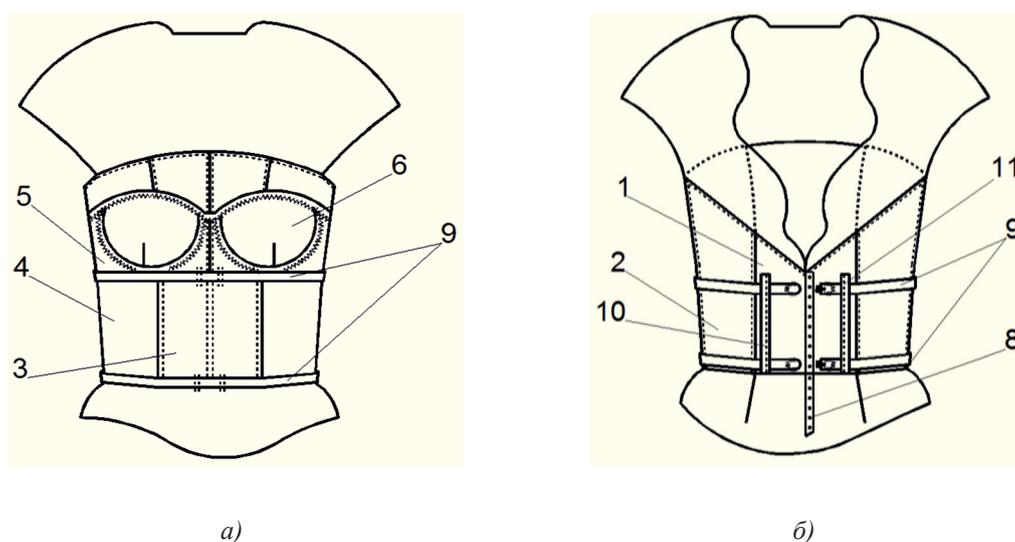
Рис. 1. Структурная схема лифа платья для торжественных случаев на корсажной основе (с обозначением деталей) (а – вид спереди, б – вид сзади)
