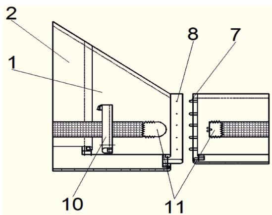
Рис. 3. Схема метода технологической обработки застежки лифа платья для торжественных случаев на корсажной основе (с обозначением деталей)
