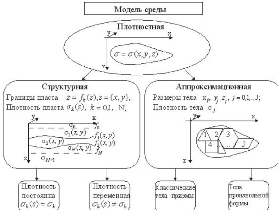
Рис. 1. Иерархическая схема объёмных моделей среды
