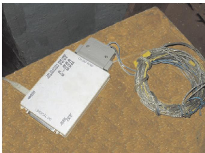
Рис. 2. Общий вид аналого-цифрового преобразователя (USB-3)
