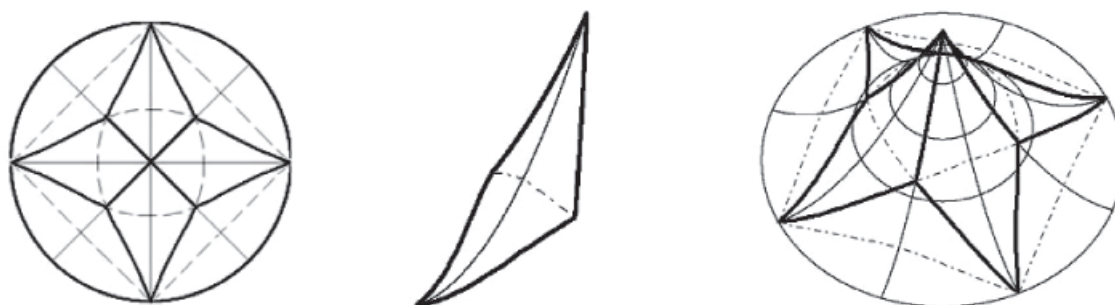
Рис. 3. Пример сборки шатра из седловых элементов (показан в центре) по кратчайшим линиям на поверхности. Слева – вид сверху, справа – в аксонометрии
