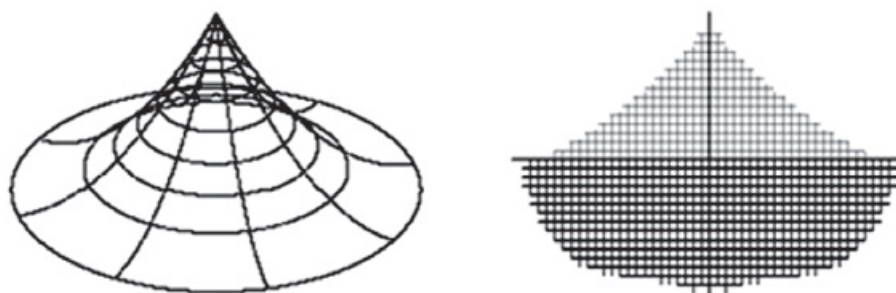
Рис. 2. Пример плоского раскрой половины поверхности шатра. Слева – общий вид шатра
