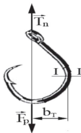
Рис. 4. Силы, приложенные к рыболовному крючку: F_p – сила, с которой рыба действует на крючок; T_n – натяжение поводца; b_T – плечо натяжения поводца
