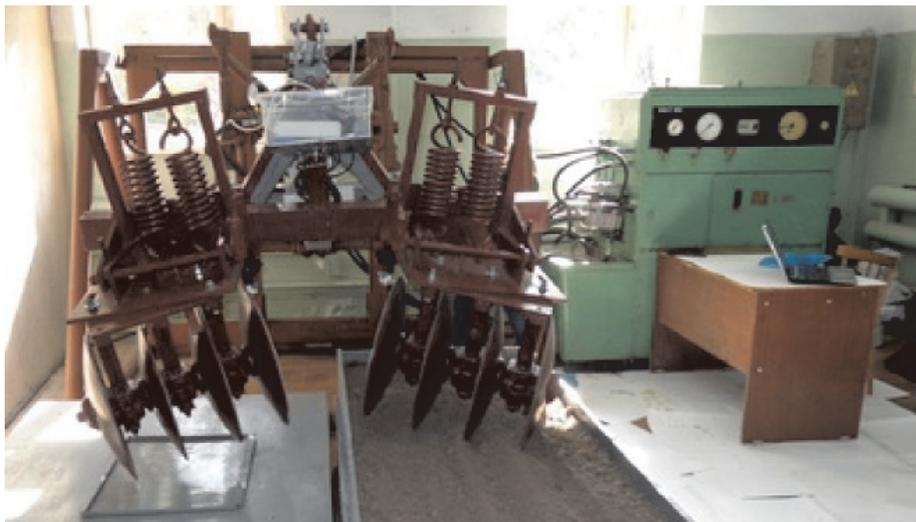
*Рис. 3. Лабораторные эксперименты с приспособлением на стенде для испытаний навесных устройств тракторов*
