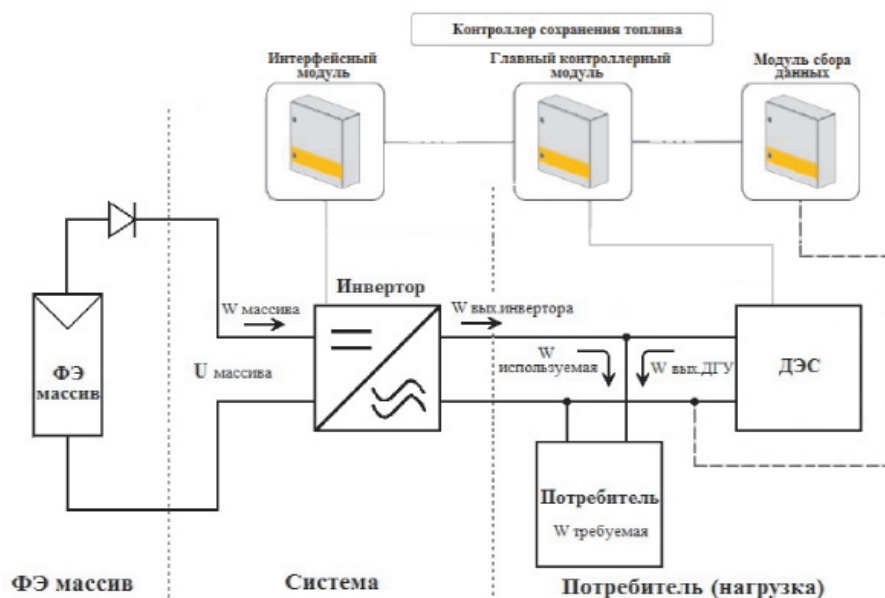
Рис. 1. Схема параллельного включения СЭС с дизельной электростанцией
