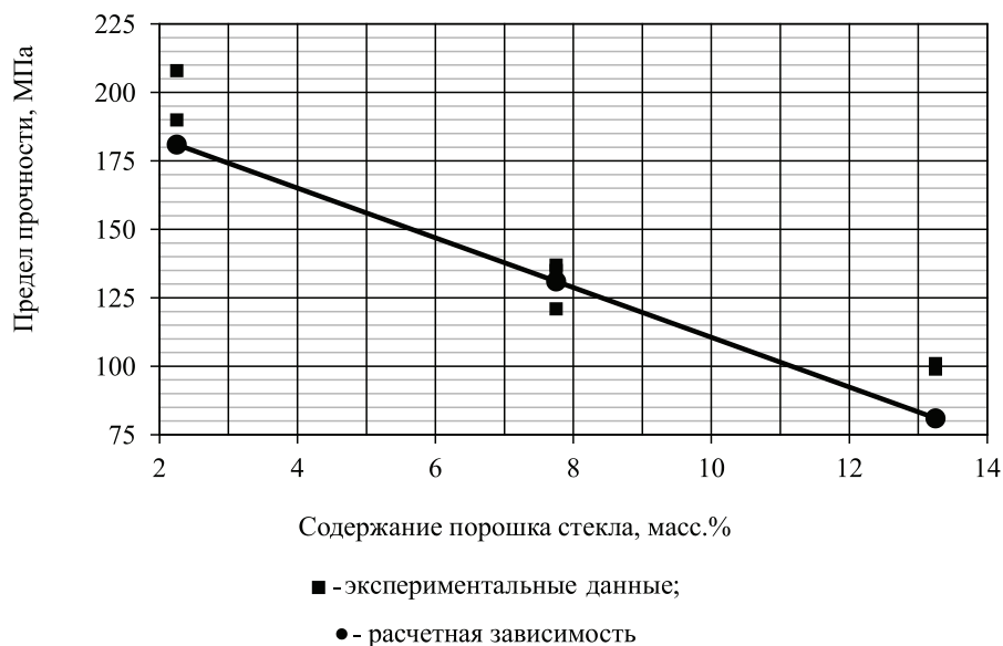
Рис. 1. Экспериментальные значения и расчетная зависимость предела прочности при растяжении от содержания порошка стекла
