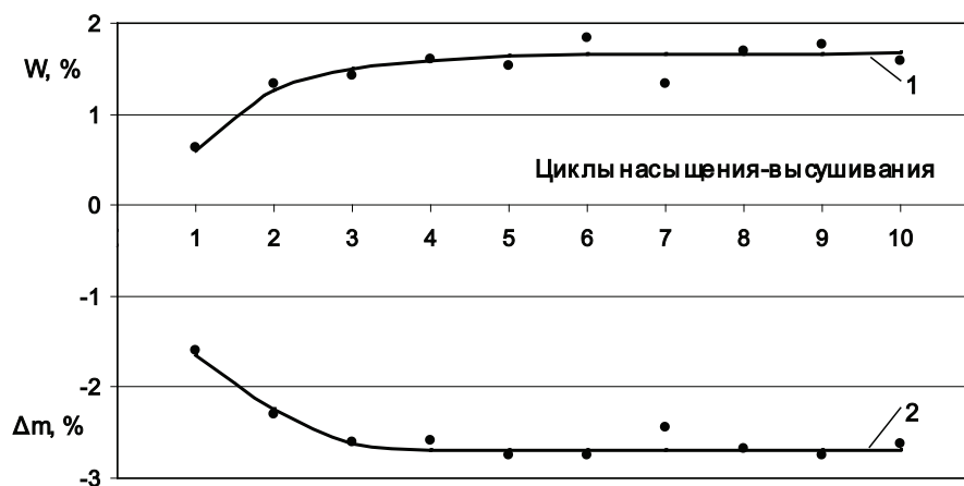
Рис. 1. Изменение водопоглощения и изменение массы бетона в процессе насыщения-высушивания
