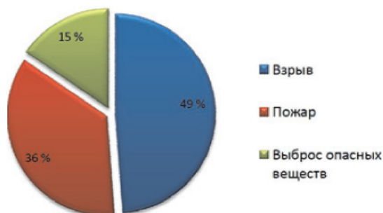
Рис. 1. Статистика аварийных ситуаций на трубчатых печах
