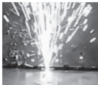
Рис. 5. Фотография процесса импульсной лазерной термообработки металла без оплавления поверхности (заковка)
