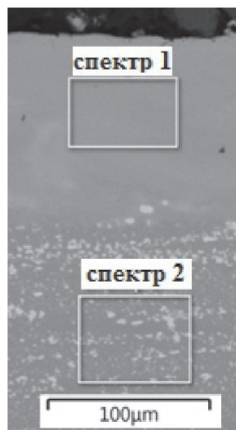
Рис. 9. Микроструктура зоны наплавки фрезы, с обозначением участков для спектрального анализа
