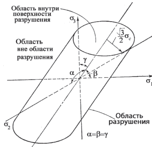
Рис. 1. Графическое представление гипотезы удельной энергии формоизменения для случая произвольного напряженного состояния
