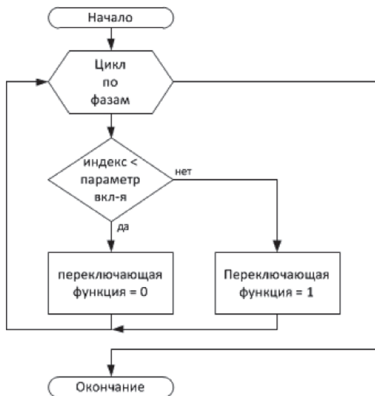
Рис. 1. Алгоритм моделирования НПЭ с однополярной ШИМ: а – формирование переключающей функции начальной фазы; б – изменение переключающей функции амплитуды
