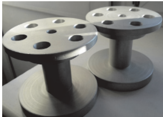
Рис. 3. Дюралюминиевые диски для установки супермагнитов
