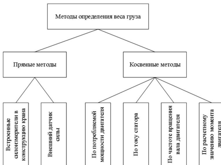
Рис. 3. Способы определения веса груза
