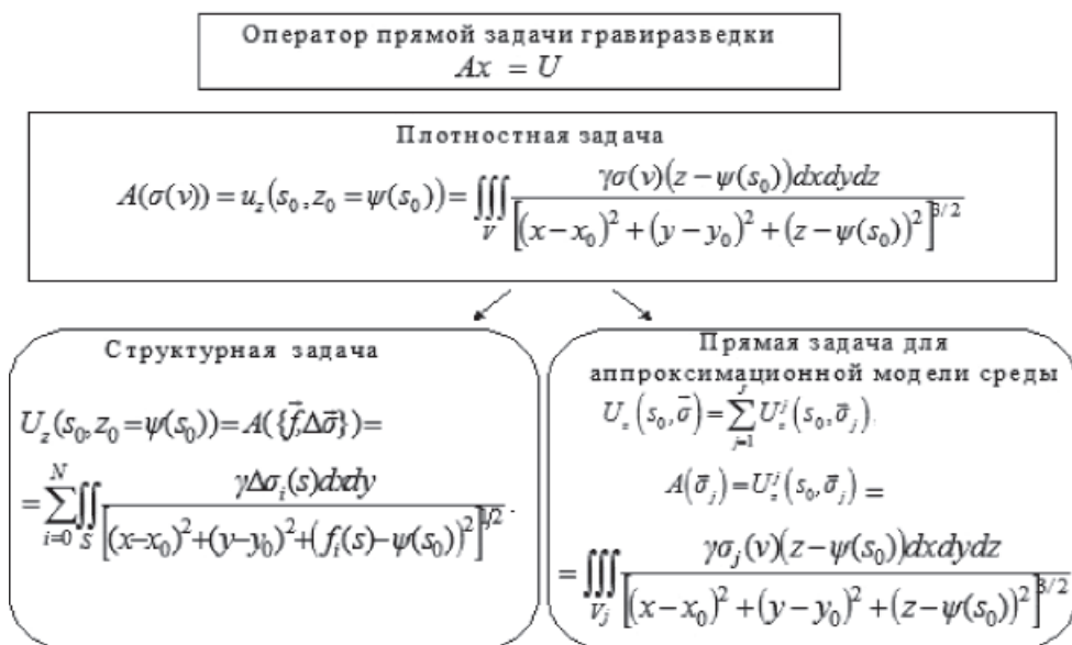
Рис. 2. Оператор объёмной прямой задачи гравirazведки для разных видов моделей среды
