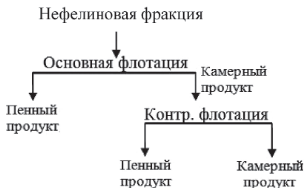
Рис. 2. Технологическая схема обратной флотации нефелина
