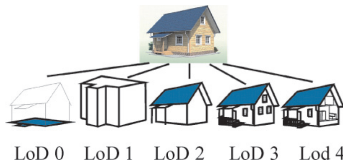
Рис. 1. Представление 3D-объекта с помощью уровней детальности по стандарту CityGML
