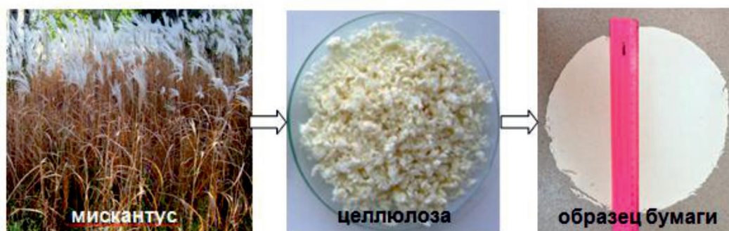
Рис. 2. Фото мискантуса, целлюлозы, полученной из него, и лабораторного листа бумаги
