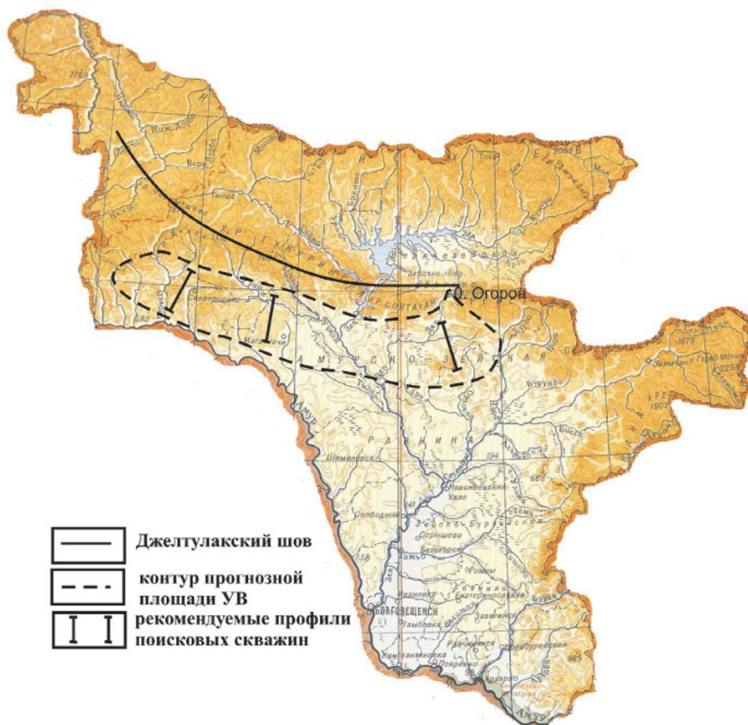
Рис. 2. Схема расположения прогнозной площади УВ на орографической карте Приамурья
