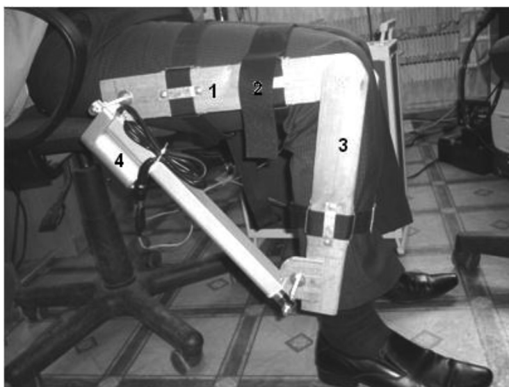
Рис. 1. Коленный мехатронный модуль в составе реабилитационного устройства для механотерапии
