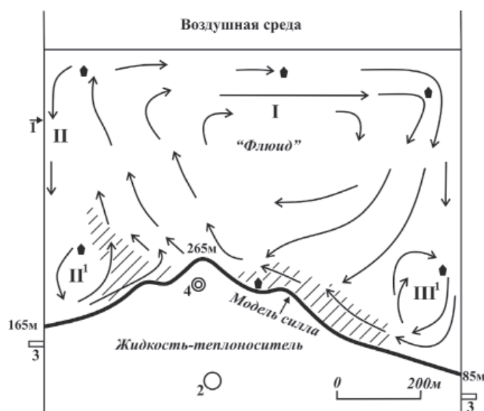
Рис. 2. Движение «флюида» над моделью внедрившегося в ЭРГС магматического силла на этапе установившейся конвекции при перепадах температур на границе «силл – флюид» 30–20°C
