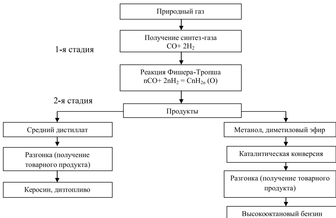
Принципиальная схема конверсии природного газа
