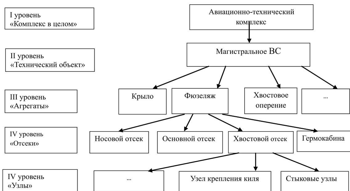
*Блочнo-иерархическая структура магистрального ТС*
