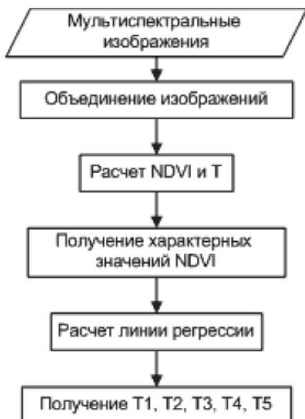
Рис. 1. Блок-схема получения характерных температур (алгоритм А1)
