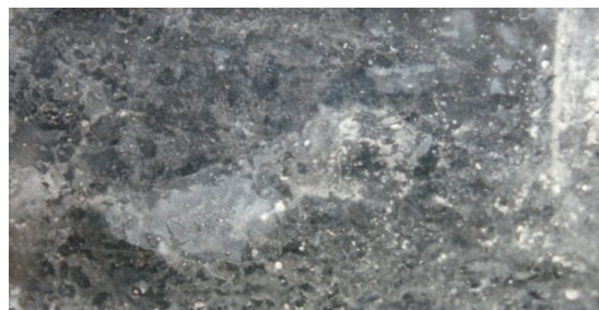
Рис. 2. Поверхность стеклянной пластины, модифицированной суспензией аэросила и высушенной на воздухе. Фото выполнено с помощью фотокамеры в режиме «макро»
