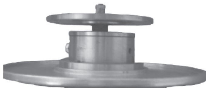
Рис. 4. Рабочий орган технологической машины с механизмом с замкнутой системой тел качения
