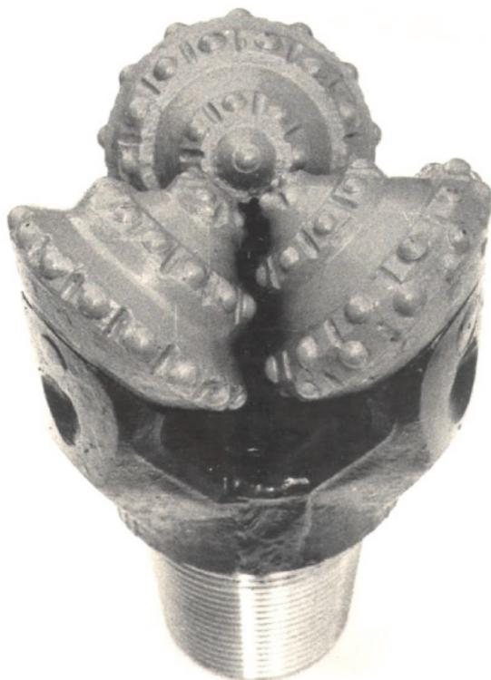
Рис. 4. Долото опытной конструкции
