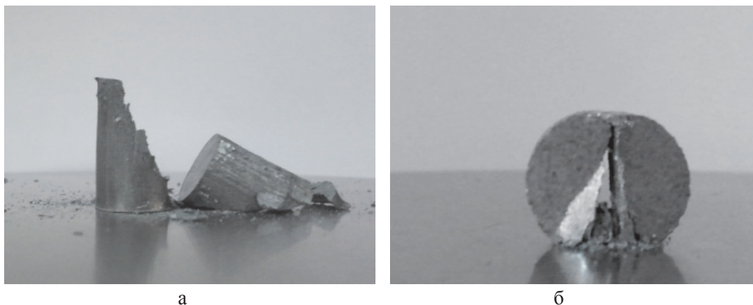
Рис. 2. Разрушенные образцы: а – осевое сжатие; б – радиальное сжатие
