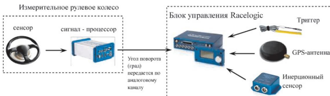
Рис. 3. Принципиальная схема соединения измерительной аппаратуры
