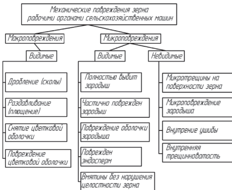
Рис. 1. Классификация механических повреждений зерна рабочими органами сельскохозяйственных машин
