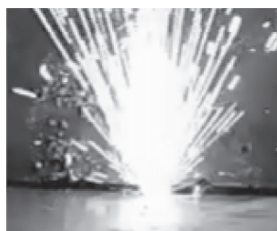
Рис. 6. Фотография процесса импульсной лазерной термообработки металла с оплавлением поверхности (наплавка)
