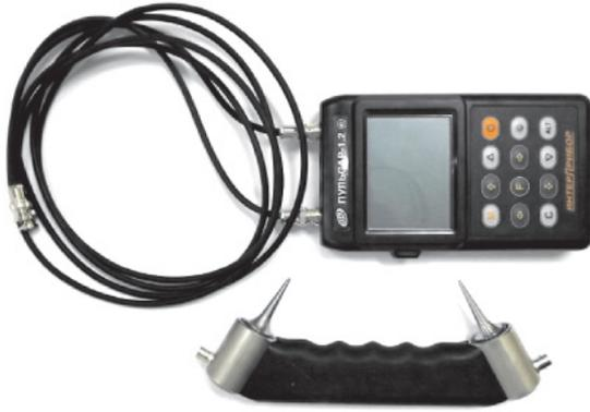
Рис. 1. Ультразвуковой дефектоскоп «Пульсар-1.2»
