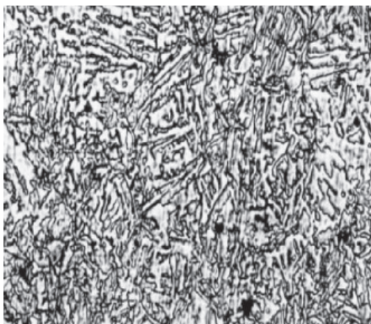
Рис. 4. Микроструктура стали 40X – сорбит с участками мартенсита (x 100)
