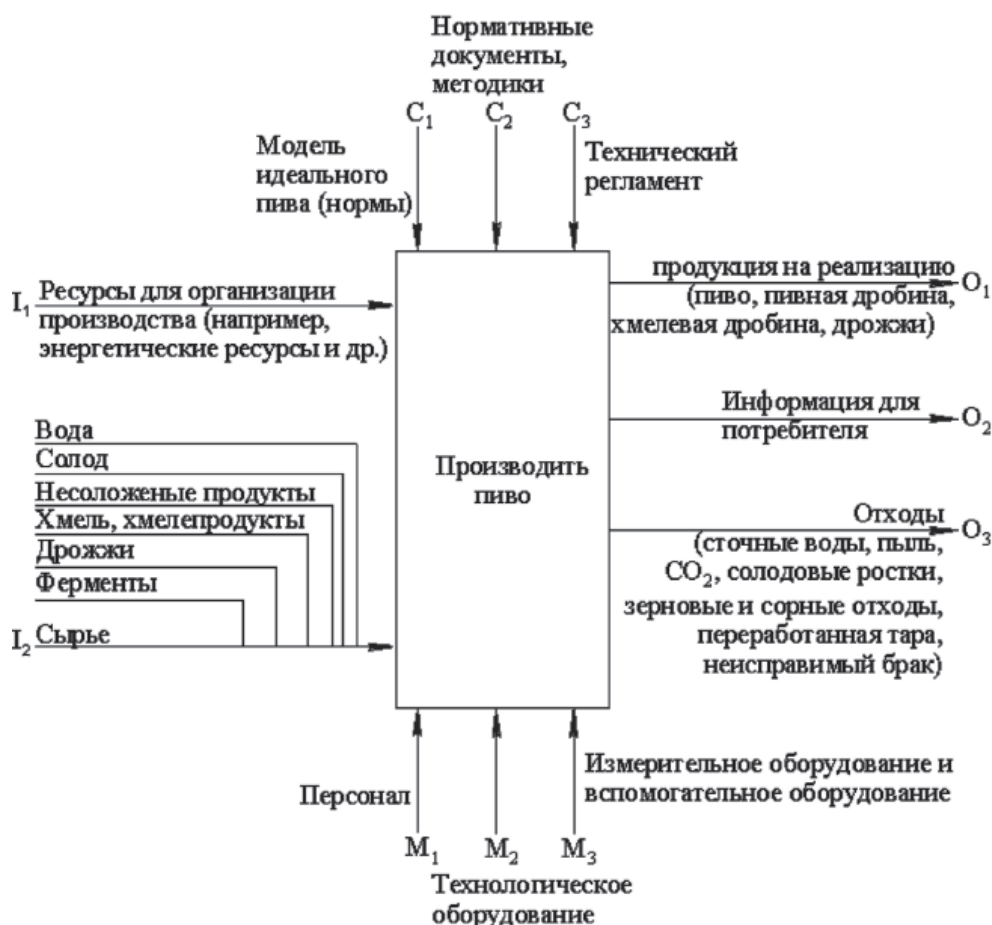
Рис. 1. Обобщенная функционально-логическая модель производства пива.
