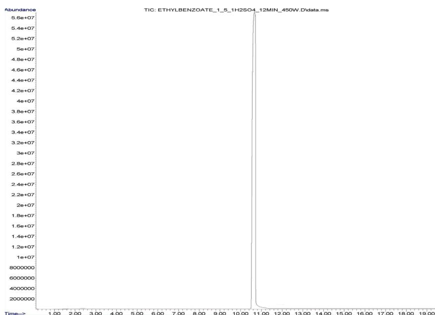
Рис. 1. Хроматограмма этилбензоата, полученного сверхвысокочастотным облучением
