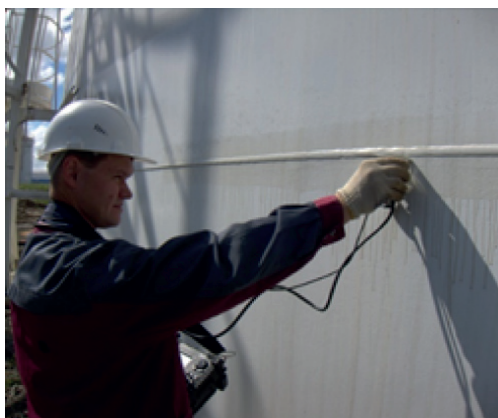
Рис. 4 а. УЗ-дефектоскопия стенки РВСПК-100000 с применением метода ФАР
