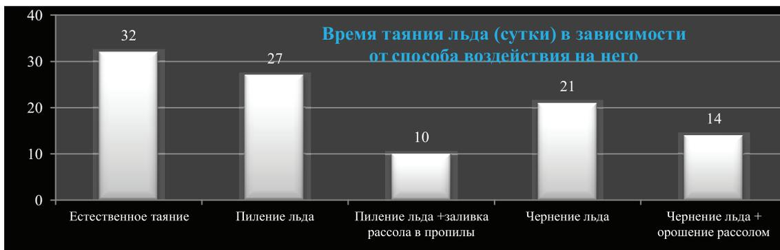
Рис. 2. Результаты испытаний по ослаблению прочности ледового покрова рек
