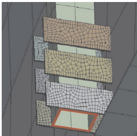
Рис. 4. Узел приложения нагрузки от гидродомкрата (поз. 8 на рис. 1) и усиливающие элементы окрайки
