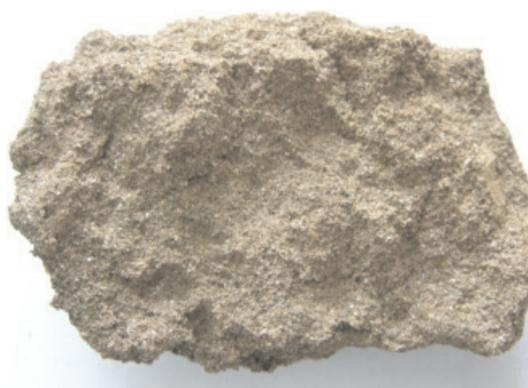
Рис. 2. Твердофазное спекание отхода
